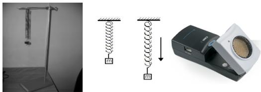
Figura 3. Artefacto de modelación del sistema MRA y sensor de movimiento
