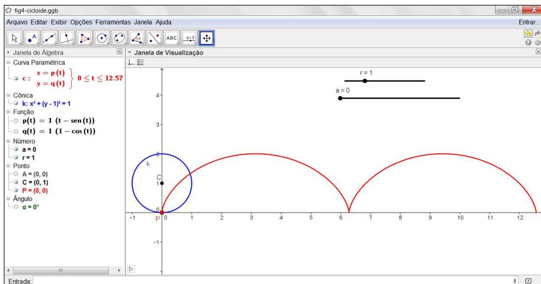
Figura 5. Equações paramétricas da cicloide.
