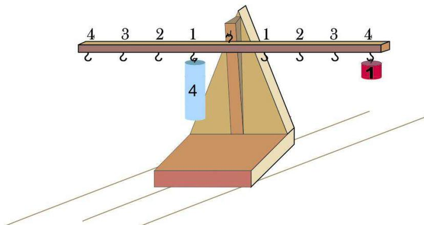
Figura 2. O princípio da alavanca verificado de maneira prática.
